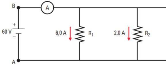
A resistência equivalente ligada aos terminais da bateria, em ohms, vale:
